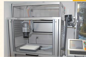
**2.** Anhand der optimierten Daten Ihrer Fußsohle fräst eine computergesteuerte Fräse Ihre Einlage millimetergenau.
